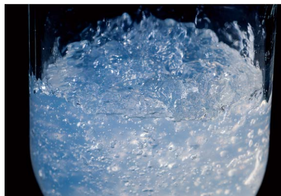
図1 疎水変性CNF（固形分5.0%）メタノール分散体の外観
