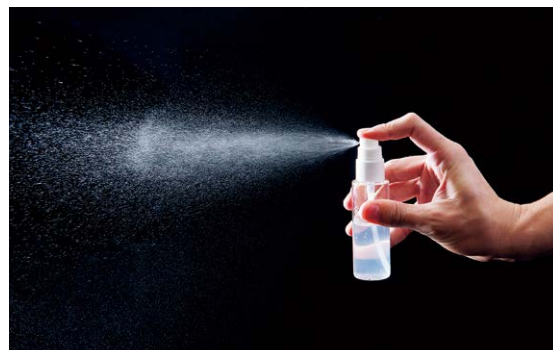
図5 メタノールに分散した疎水変性CNF（固形分4.0%）のスプレー噴霧
