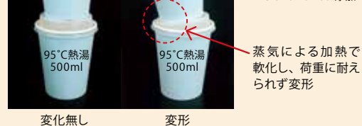
図2 TRIBIO S-920MBの荷重耐熱性評価
