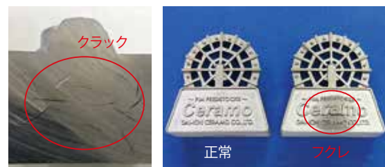
図7 内部クラック不良例 (写真は切断した焼結体)
