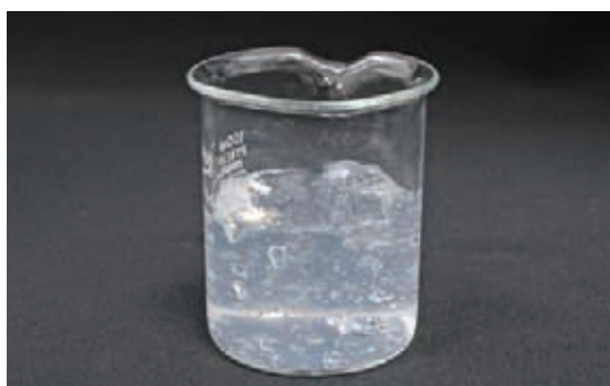
図1 CSNF水分散物 (固形分2wt%) の外観
