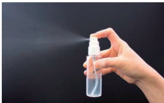
図5 CSNF (固形分0.5wt%) ゲルのスプレー噴霧
