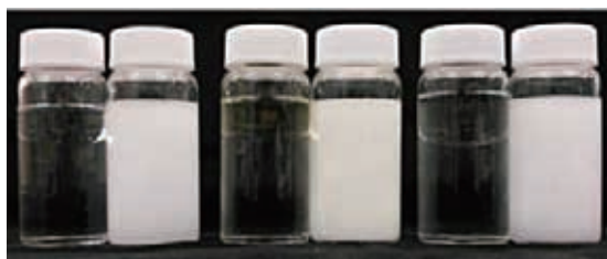
図6 CSNFによる各種オイルの乳化安定効果
