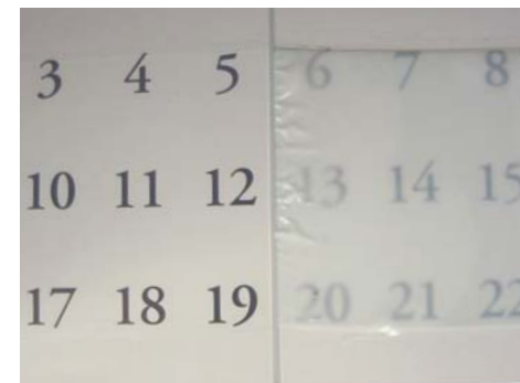
図7 耐水性試験の外観
